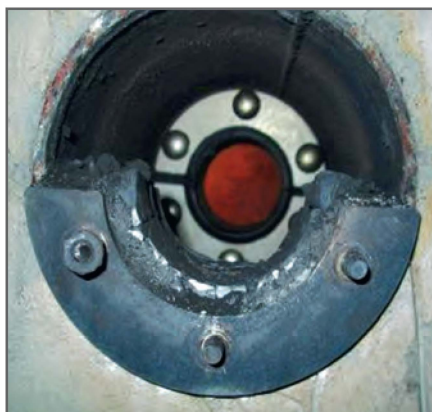
Вид проходки силового кабеля ААШв 3х120-10 после огневых испытаний
