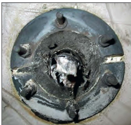
Вид проходки силового кабеля ААШв 3х120-10 после огневых испытаний
